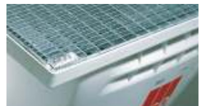
Négyzetátlós rács (30x10), gyalogos terhelhetőségű 1,5kN-ig, személygépkocsi terhelhetőségű, 9kN-ig ráparkolható.
