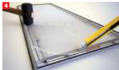
4 Vezesse a fal csatlakozó profilt a horonyba. Dugja bele a kefék szigetelést a horonyba. Egyengesse a szövetet a fedélre. Egyengesse ki a keletkező hibákat gumikalapáccsal. Vágja körbe a szövetet a sarokráma körül.
